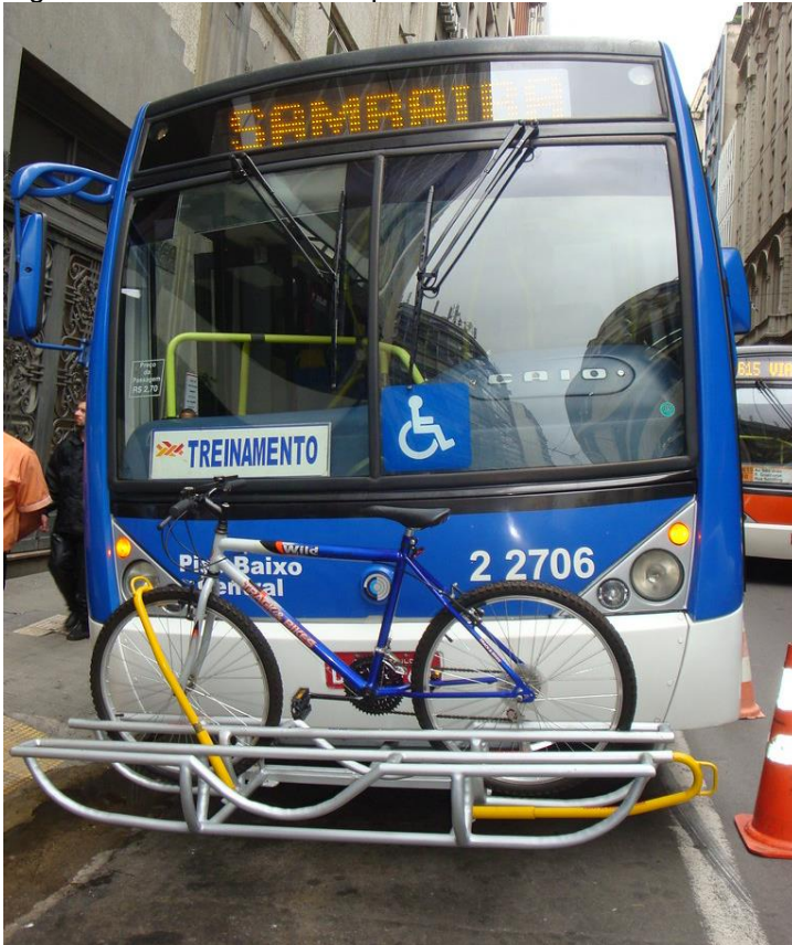
Figura 65 – Modelo de rack para bicicleta instalado em veículo de transporte coletivo em São Paulo
