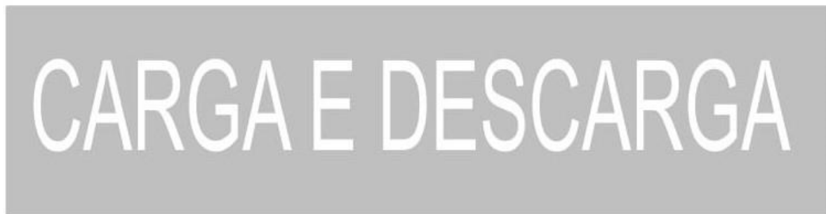
Figura 68 - Sinalização horizontal vaga para carga e descarga
