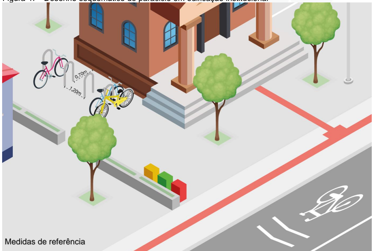
Figura 47 - Desenho esquemático de paraciclo em edificação institucional
